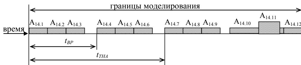
Рисунок 6 – Временная шкала процесса целеуказания и наведения: t_{BP} – период времени от начала управления до входа группы в район цели; t_{TNA} – период времени от начала управления до входа группы в ТНА
