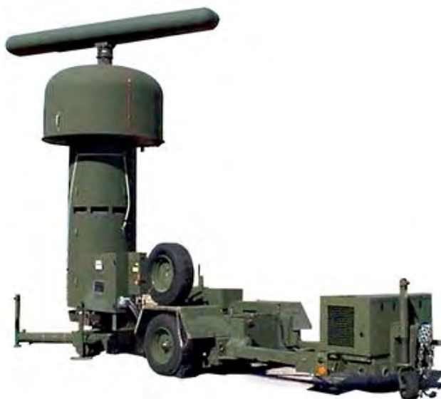
Рисунок 4 – Мобильный комплект AN/MPN-25 в развернутом состоянии
