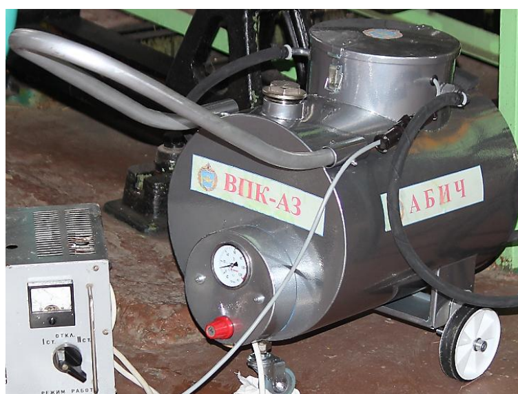
Рисунок 4 – Опытный образец устройства для безразборного восстановления ТА дизельных ДВС
