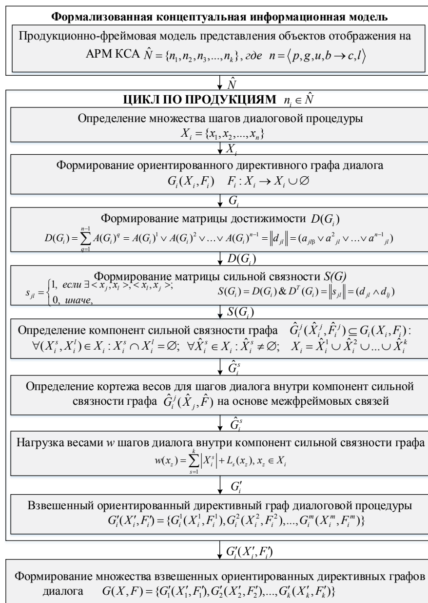
Рисунок 1 – Способ формирования графовой модели диалогового режима решения автоматизированных задач управления на естественно-подобном языке
