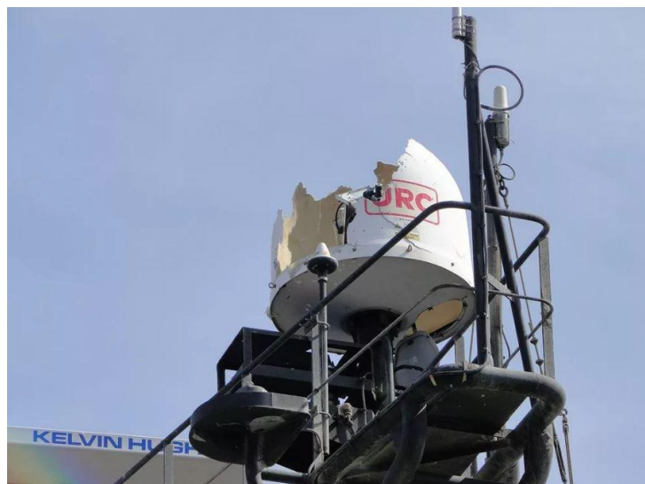
Рисунок 4 – Радар, поврежденный боеприпасом малого калибра
