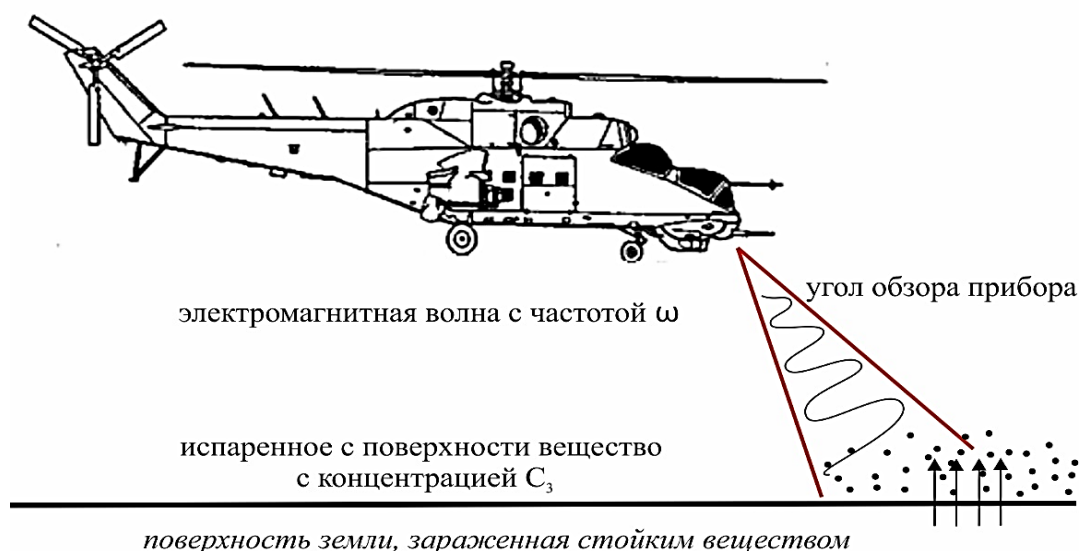
Рисунок 2 – Влияние воздействия ЭМВ СВЧ-диапазона на парообразование химических веществ с зараженной поверхности
