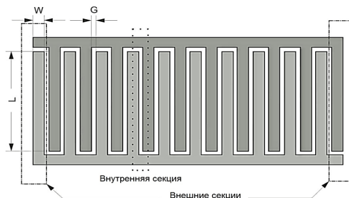
Рисунок 2 – Схема гребенчатого конденсатора, модель Игрия
