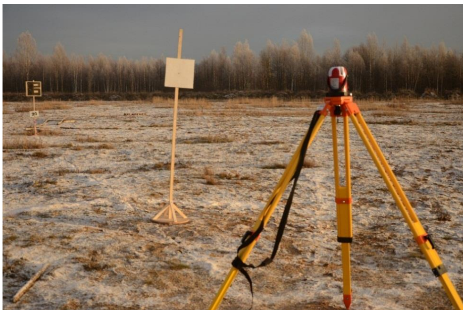
Рисунок 2 – Определение координат точек падения ГММ СНК новым способом
