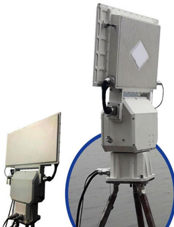
Рисунок 6 – Радар обнаружения БЛА «Стопдрон-Горизонт»
