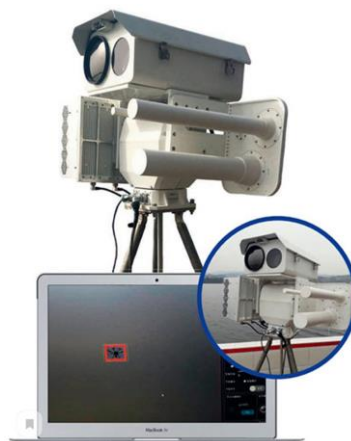
Рисунок 7 – Комплекс оптического распознавания и направленного прерывания сигнала БЛА «Стопдрон-Импульс»
