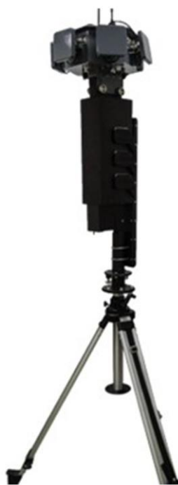
Рисунок 2 – Мобильная система обнаружения БЛА «Снегирь»
