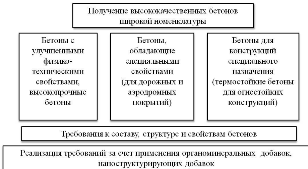
Рисунок 2 – Виды бетонов, получаемых за счет применения органоминеральных и наноструктурирующих добавок
