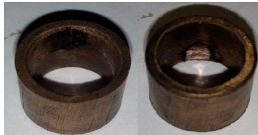
Рисунок 5 – Образец № 1 после испытаний с изменением скорости скольжения
