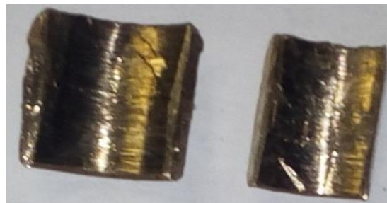
Рисунок 6 – Образец № 2 после испытаний с изменением скорости скольжения
