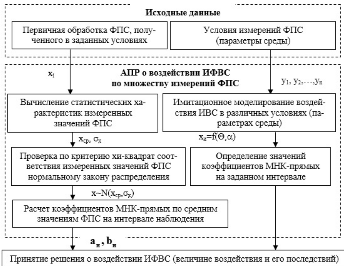
Рисунок 2 – Блок-схема АПР о воздействии ИФВС по множеству значений ФПС на коротком интервале наблюдения (КВИ)
