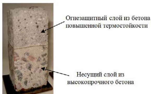
Рисунок 5 – Образец вариатропной двухслойной конструкции с огнезащитным слоем
