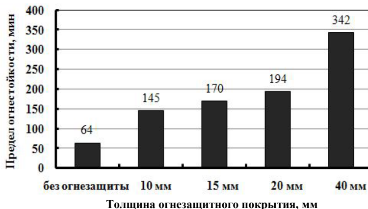
Рисунок 6 – Зависимость огнестойкости конструкции от толщины огнезащитного слоя
