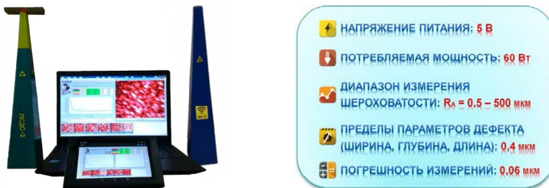
Рисунок 4 – Внешний вид и характеристики оптико-электронного комплекса неразрушающего контроля
