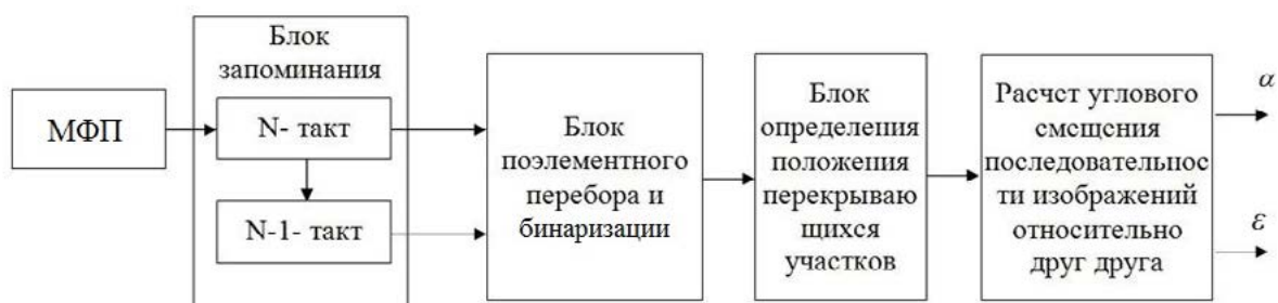
Рисунок 4 – Вычислительная схема пространственно-временной обработки кадров
