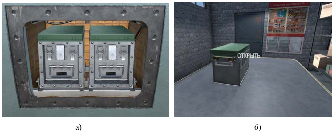
Рисунок 5 – Процесс снятия и осмотра аккумуляторных батарей а) люк для доступа к аккумуляторным батареям; б) рабочее место для визуального осмотра АКБ
