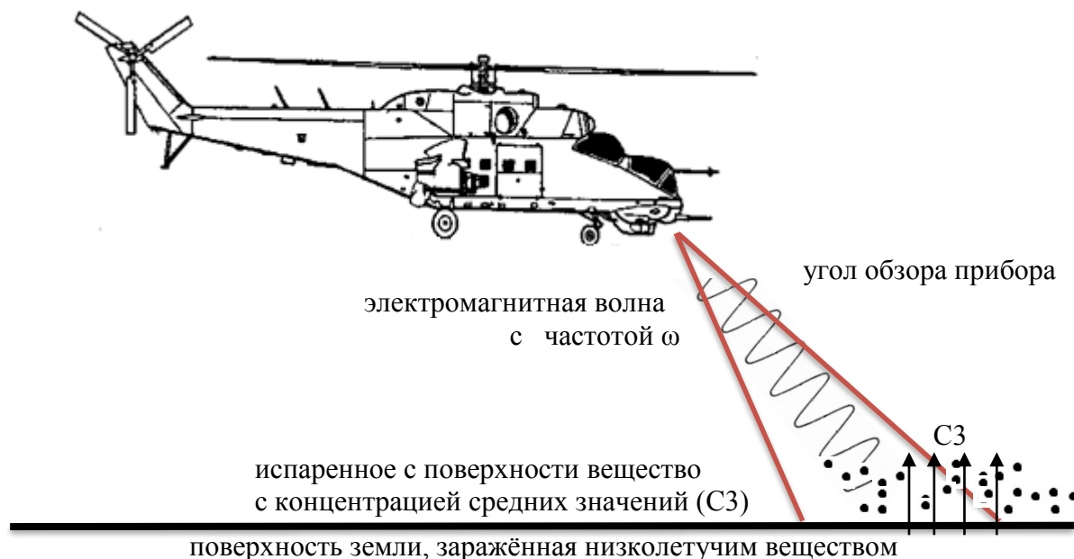
Рисунок 2 – Образование градиента концентрации под воздействием электромагнитного излучения сверхвысокой частоты
