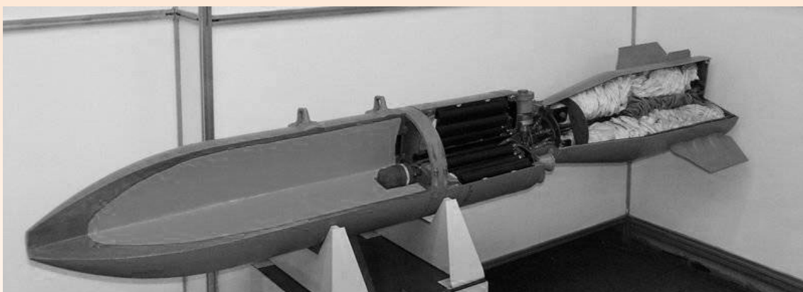
Рисунок 2 – Российская бетонобойная бомба БетАБ 500ШП в разрезе
